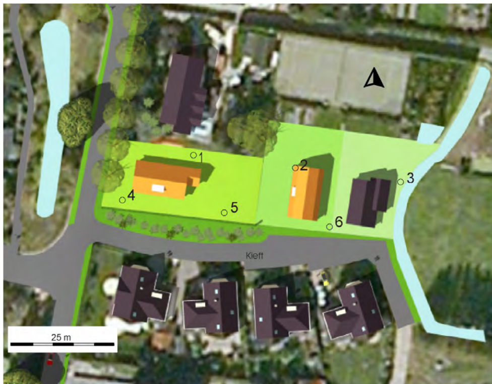
Figuur 8. Sint Pancras, Kievit. Bouwplan met boorpunten. De genummerde punten geven de boorpunten aan. [Bron: BügelHajema Adviseurs bv.]
