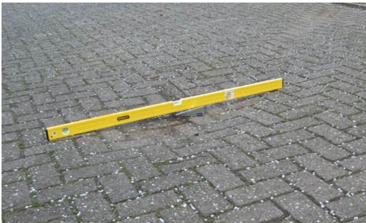
Figuur 3: – Meetinstrument voor methode visuele gestandaardiseerde vlakheidsmeting
