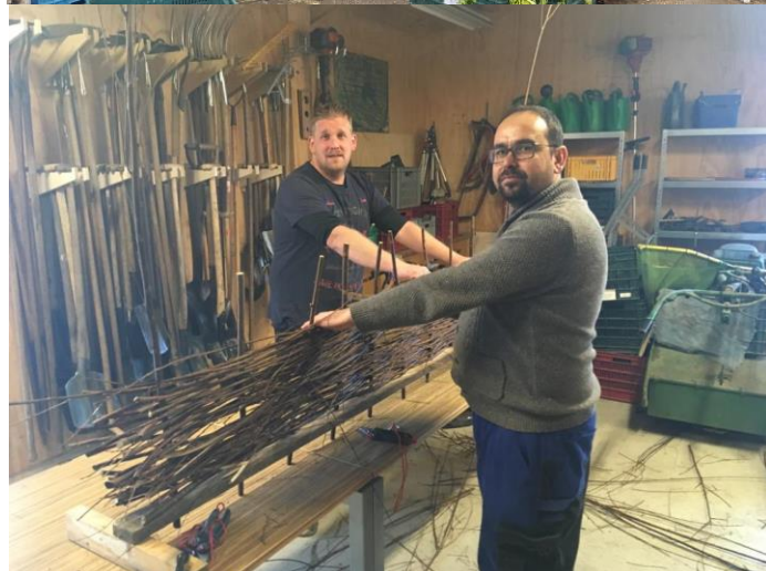
zij op de eilanden maar bij slecht weer zijn ze in de werkplaats te vinden waar ze onder andere wiepen vlechten. De wiepen worden gebruikt om de oevers te beschermen tegen instorten en de kreeftenplaag.
